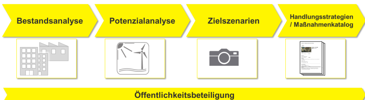
Abbildung 1: Übersicht der Arbeitsphasen einer KWP
